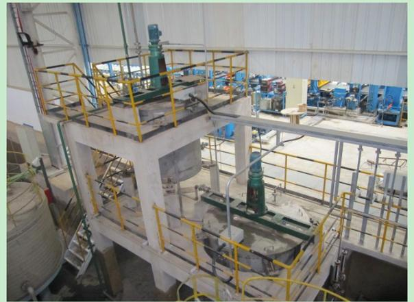
该项目是为某集团公司钛带冷轧工程新建的连续酸洗机组设计的氮氧化物净化系统。由于机组酸洗段的混酸酸洗槽、清洗槽、酸液循环罐等在运行时会产生含混合酸的废气，因此须将产生的酸性废气用集气罩导入到酸雾洗涤塔，用质量分数为 10%的  $\text{Na}_2\text{CO}_3$  和  $\text{NaOH}$  的混合液吸收。
