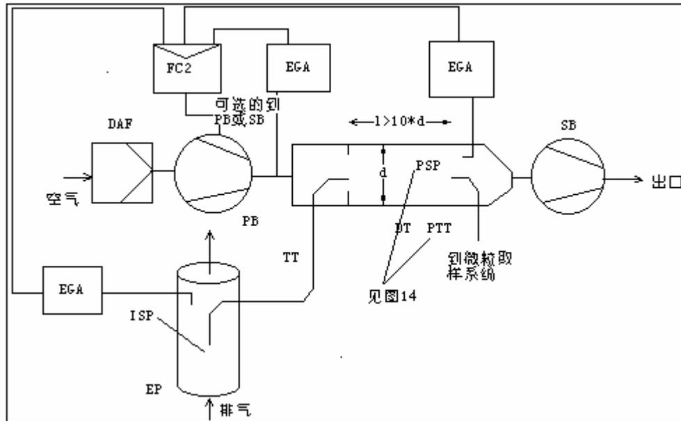
原始排气从排气管 EP，由取样探头 SP 采样，通过输送管 TT 输送到稀释通道 DT。原始排气、稀释排气和稀释空气中的示踪气(CO<sub>2</sub> 或 NO<sub>x</sub>)的浓度用排气分析仪 EGA 测量。这些信号传送到流量控制器 FC2，FC2 控制排气风机 PB 或抽气风机 SB，以保持期望的排气分流比和 DT 中的稀释比。根据原始排气、稀释排气和稀释空气中示踪气的浓度计算稀释比。
