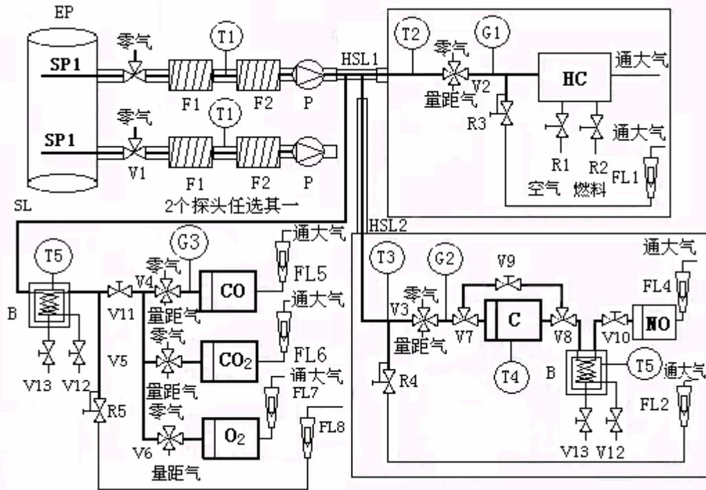
图 3 测量稀释排气的 CO, CO<sub>2</sub>, NO<sub>x</sub>和 HC 分析系统流程图
