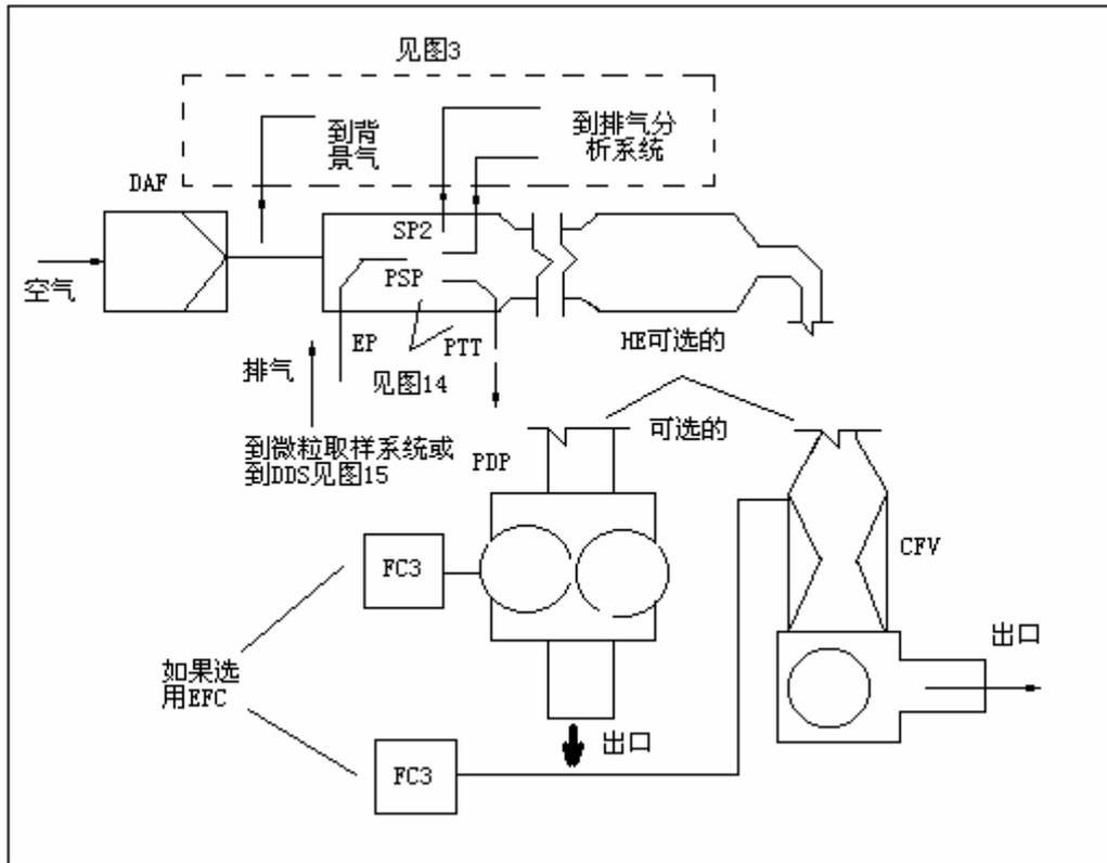
全部原始排气需在稀释通道 DT 内与稀释空气混合。
