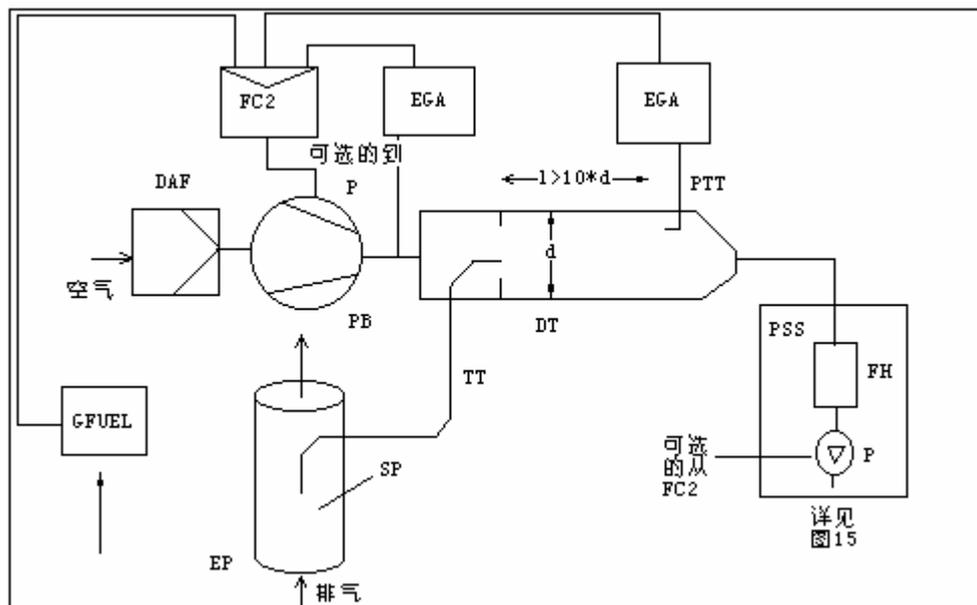
原始排气从排气管 EP，由取样探头 SP 采样，通过输送管 TT 输送到稀释通道 DT。稀释排气和稀释空气中的 CO<sub>2</sub> 浓度用排气分析仪 EGA 测量。CO<sub>2</sub> 和燃油流量 G<sub>FUEL</sub> 信号传送到流量控
