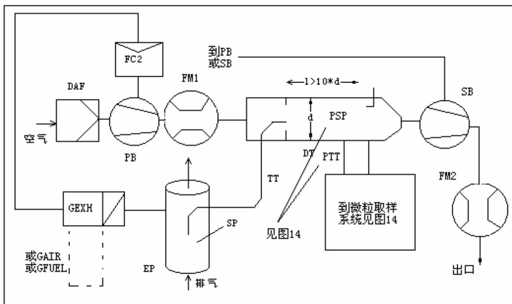
原始排气从排气管 EP，由取样探头 SP 采样，通过输送管 TT 输送到稀释通道 DT。排气分流和进入 DT 的流量由流量控制器 FC2 控制，根据需要，FC2 调节压力风机 PB 或抽气风机 SB
