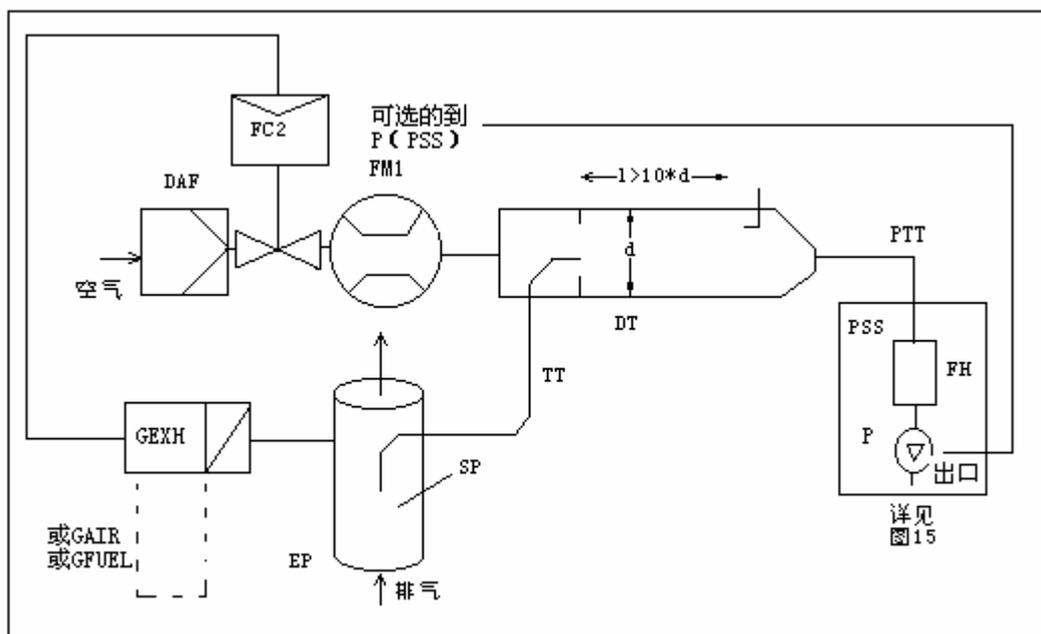
原始排气从排气管 EP，由取样探头 SP 采样，通过输送管 TT 输送到稀释通道 DT。通过稀释通道的总流量由颗粒物取样系统（见图 16）的流量控制器 FC3 和取样泵 P 调节。稀释空气流量由流量控制器 FC2 控制，使用  $G_{EXH}$ 、 $G_{AIR}$  或  $G_{FUEL}$  作为命令信号来获得期望的排气分流。进入 DT 的取样流量是总流量和稀释空气流量的差。稀释空气流量用流量测量装置 FM1 测量，总气体流量用颗粒物取样系统中（图 14）的流量测量装置 FM3 测量。根据这两种流量计算稀释比。
