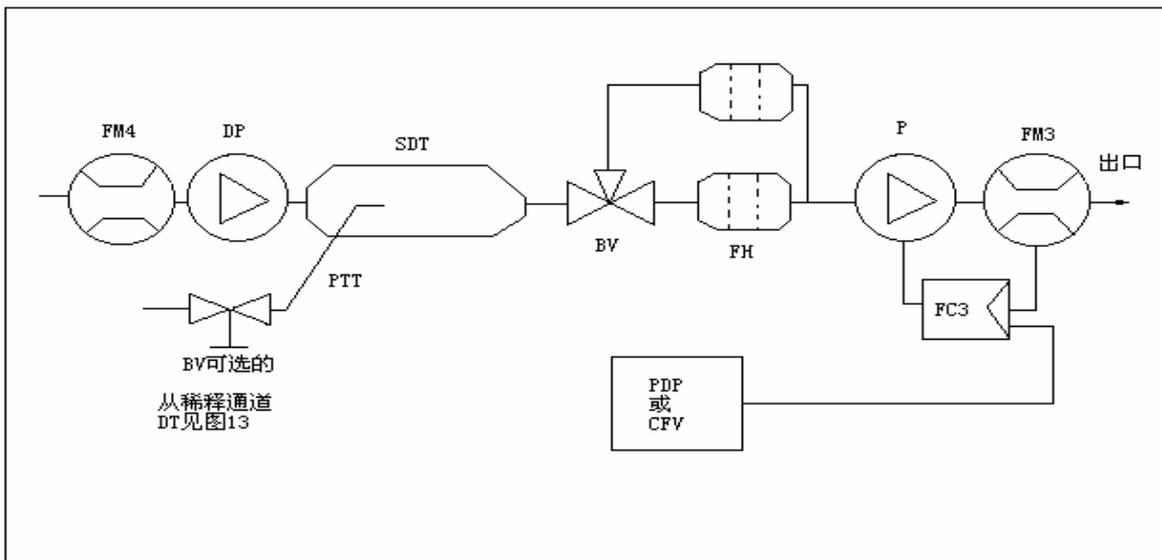
稀释排气的样气从全流稀释系统的稀释通道 DT，通过颗粒物取样探头 PSP 和颗粒物输送管 PTT 传送到二级稀释通道 SDT，在那里被进一步稀释。然后，样气通过装有颗粒物取样滤纸的滤纸保持架 FH。当取样流量由流量控制器 FC3 控制时，稀释空气流量通常是稳定的。如果采用电子流量补偿装置 EFC(见图 13)，总稀释排气流量通常作为 FC3 的控制信号。
