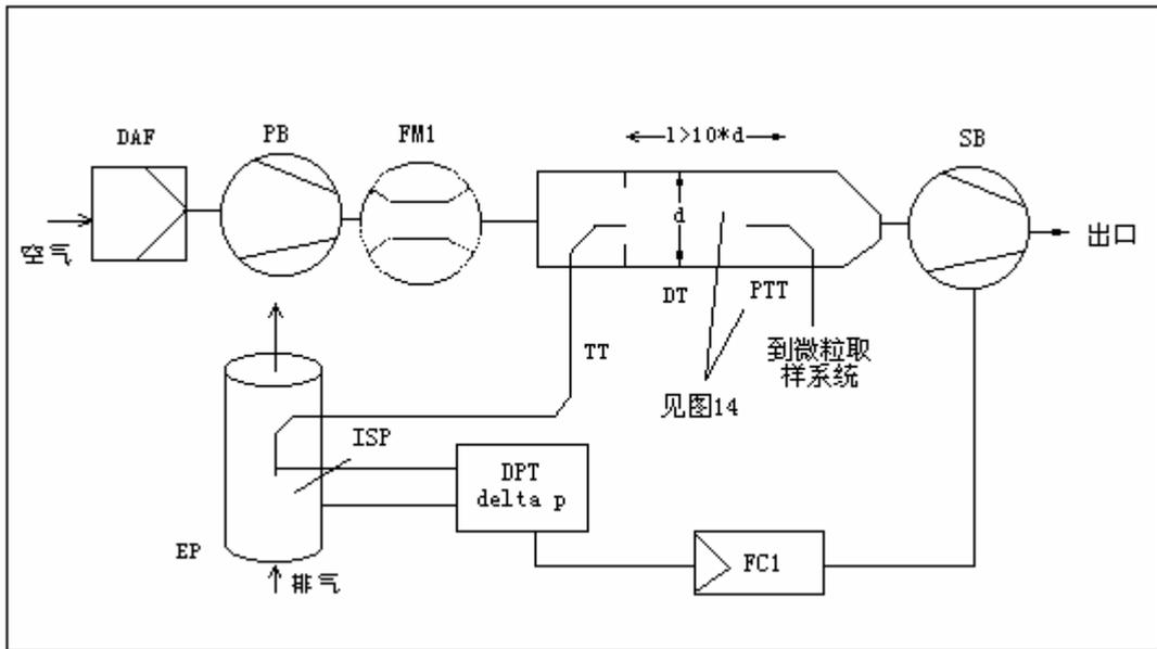
原始排气从排气管 EP，由等动态取样探头 ISP 采样，通过输送管 TT 输送到稀释通道 DT。排气管和探头进口之间的排气压差用压力传感器 DPT 测量。这个信号传送到流量控制器 FC1，FC1 控制抽气风机 SB 使在探头末端维持零压差。在这些条件下，在 EP 和 ISP 中的排气速度是相同的，通过 ISP 和 TT 的流量相对于排气流量是一个固定的比例。分流比可以根据 EP 和 ISP 的横截面面积计算。稀释空气流量用流量测量装置 FM1 测量，稀释比可以根据稀释空气流量和分流比计算。
