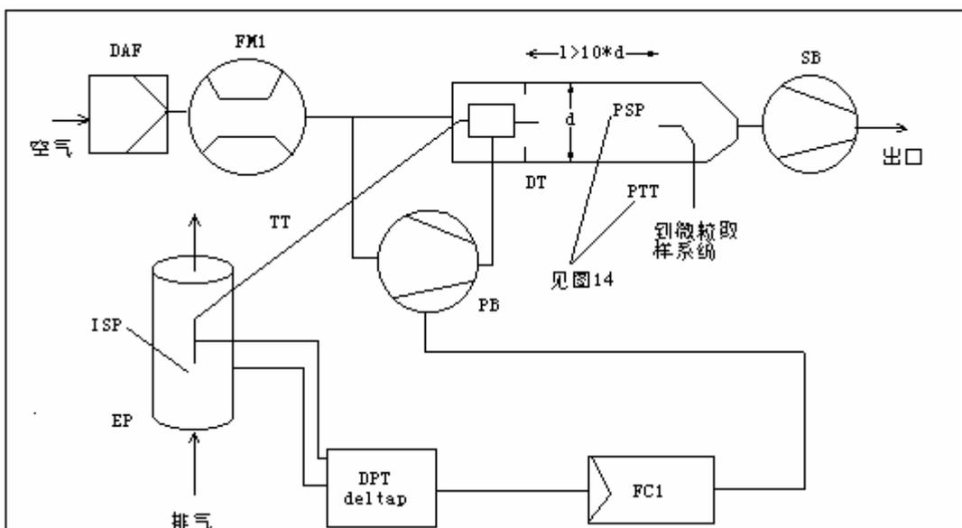
原始排气从排气管 EP，由等动态取样探头 ISP 采样，通过输送管 TT 输送到稀释通道 DT。排气管和探头进口之间的排气压差用压力传感器 DPT 测量。这个信号传送到流量控制器 FC1，FC1 控制抽气风机 PB 使在探头末端维持零压差。稀释空气流量由流量测量装置 FM1 测量，从稀释空气中取一部分稀释空气，并用一气动孔板把它送回 TT。在这些条件下，在 EP 和 ISP 中
