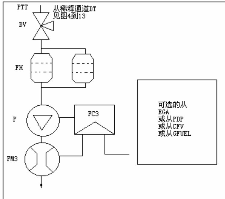
利用取样泵 P, 稀释排气样气通过颗粒物取样探头 PSP 和颗粒物输送管 PTT、稀释通道 DT 从部分流或全流稀释系统中取出。样气通过包含有颗粒物取样滤纸的滤纸保持架。样气流量由流量控制器 FC3 控制。如果使用电子流量补偿器 EFC(见图 13), 稀释排气流量可以作为 FC3 的控制信号。
